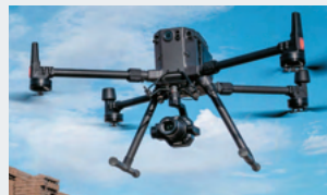
MATRICE 300 RTKにZENMUSE P1搭載時 ※MATRICE 300 RTKは別売です。
