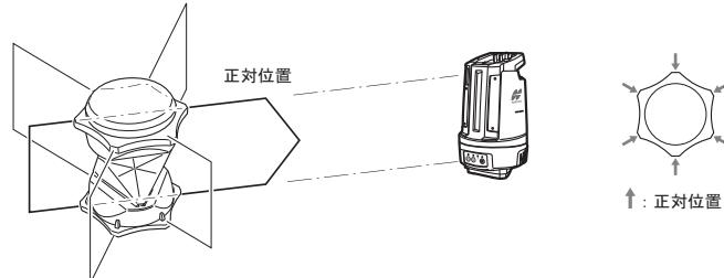
ATP2SII：プリズム上面の6本の印を直線に結ぶ線上が、水平方向の正対位置です。
