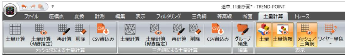
メッシュ法による土量計算の手順を説明します。(ここでは、サンプルデータ「12\_掘削後.txt」と「12\_掘削前.txt」を別グループとして読み込んで操作をおこなっています。)
