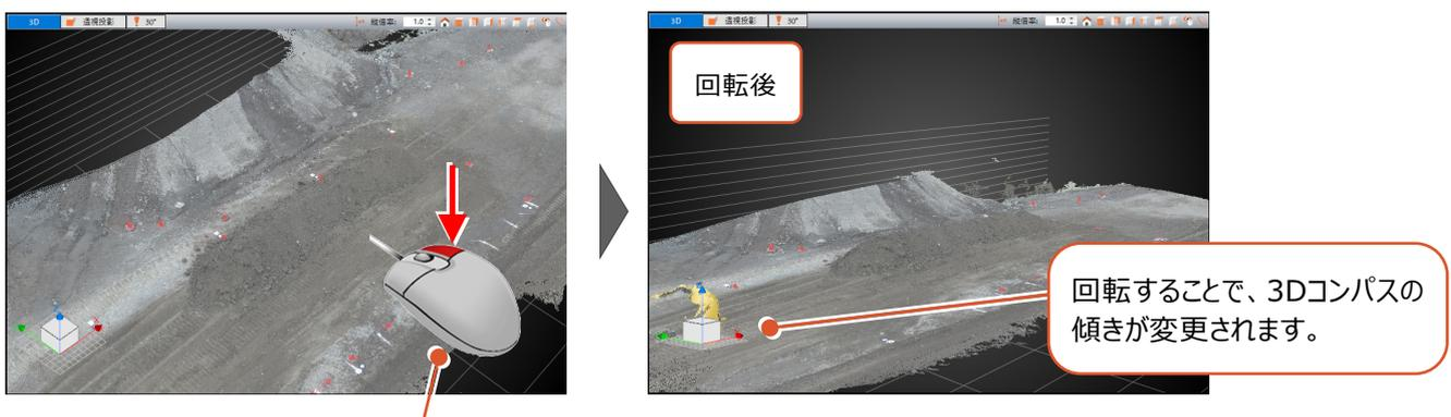
右ボタンを押したままにすると回転マーク
