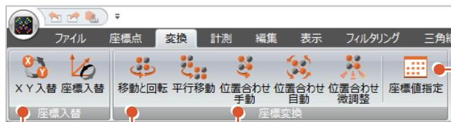
**【XY入替】**：点群読み込み時に「数学座標系」と「測量座標系」の設定を誤って、X,Y座標が逆になった場合に使用します。
